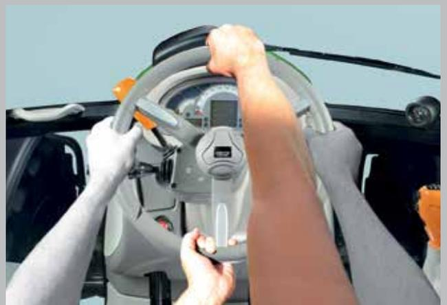
El rápido sistema de dirección SDD. La mitad de giro del volante, el doble de potencia en la dirección.
