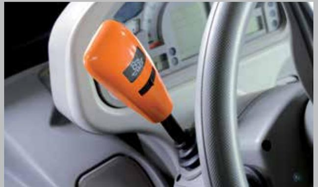
Inversor hidráulico de serie. Inversor electrohidráulico con regulación de cinco etapas
