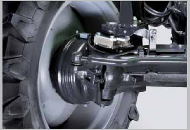
Un concepto de seguridad único de DEUTZ-FAHR. Discos de freno separados refrigerados por aceite en las ruedas delanteras.
